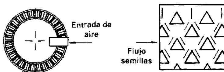
Detalle cámara de secado
